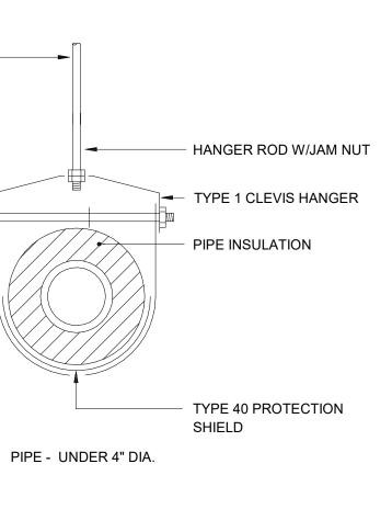
3 TYPICAL PIPE HANGER DETAIL NTS
